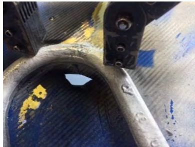
ภาพตัวอย่างการตรวจสอบแบบ NDT ด้วยวิธีการสนามแม่เหล็ก (ภาพซ้าย) และอุปกรณ์ที่ใช้ (ภาพขวา)
